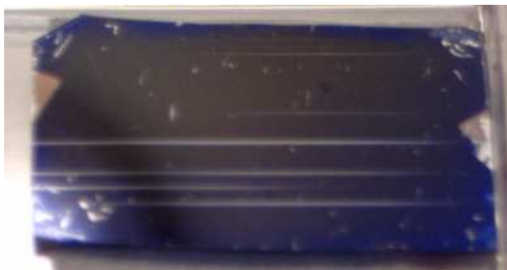
Abbildung 6.7: Foto der Probe M058 mit Strahlenschäden. Wenn die Probe zu lange dem direkten Strahl (ohne Absorber) ausgesetzt ist, wird sie durch die Strahlung verändert und schließlich lokal zerstört, wie auf diesem Bild gut zu erkennen ist. Aus diesem Grund wurde die Probe nach jeder Korrelationsmessung um 0,5 mm bis 1 mm senkrecht zum Strahl verschoben, um immer eine möglichst unbeschädigte Stelle der Probe zu untersuchen.
