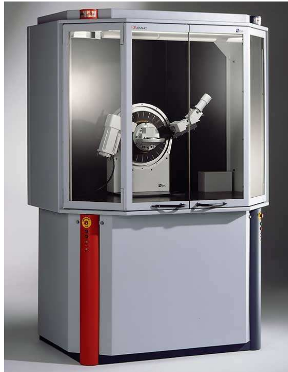
Abbildung 4.5: Das D8-Diffraktometer im Dortmunder Labor: Links ist die Röntgenröhre zu sehen, in der Mitte der in alle drei Raumrichtungen bewegliche Proben­tisch und rechts der Detektor.
